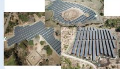
● 다산에너지혁신공원(LG전자 빌딩) 태양광 설치(210kW급)/LG모듈
